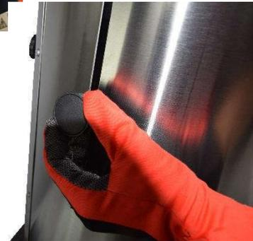
**Schritt 3:** Führen Sie den Reflektor gemäß Abbildung unterhalb des Brenners ein und befestigen diesen mit den Feststellschrauben, in dem die runden Distanzmuffen, innen zwischen dem Reflektor und dem Gehäuse angebracht sind. Die Feststellschrauben werden von außen durch den langem Schlitz im Gehäuse befestigt.
