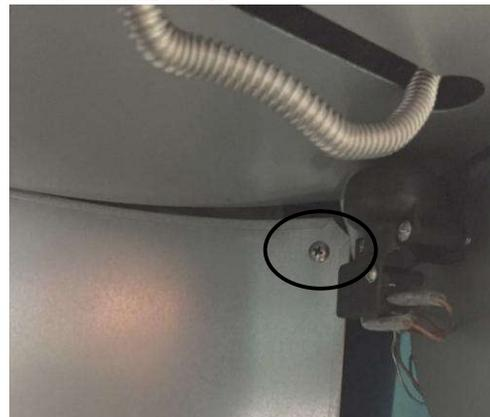
**Schritt 5:** Schieben Sie die Gegenplatte auf die Schrauben der Sechskant-Distanzmuffen, falls notwendig, drehen Sie die Schraube etwas aus der Muffe raus. Dann die Gegenplatte unterhalb des Brenners gemäß Abbildung festziehen.
