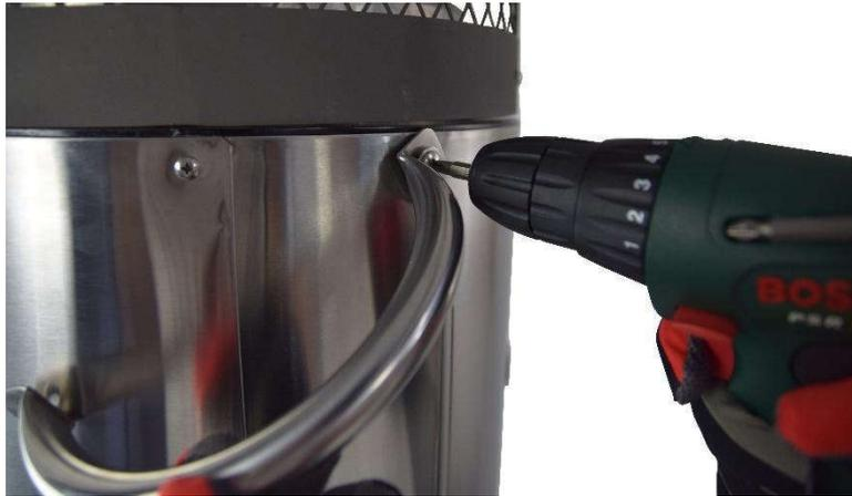
**Schritt 7:** Befestigung des Handgriffs, von außen durch das Gehäuse an den Brenner.
