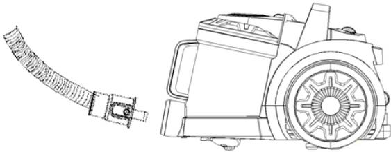
2. Fügen Sie das Ende der gebogenen Schlauchverlängerung in das Rohr ein.
