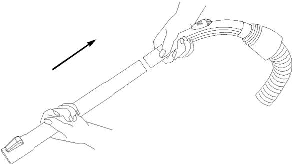
3. Schieben Sie das Rohr in die Bodenbürste. Stellen Sie das Rohr auf die gewünschte Länge ein.
