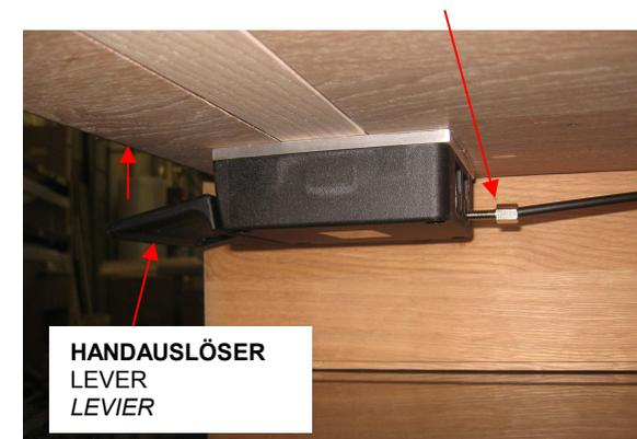
**Beim Herausdrehen der Schraube wird die Bowdenzugkraft verstärkt.**
