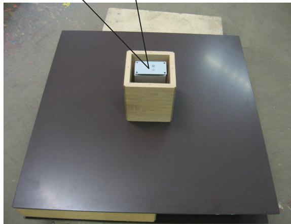
(c) Metallplatte von der Holzsockelplatte mit den Spaxschrauben außen lösen.
