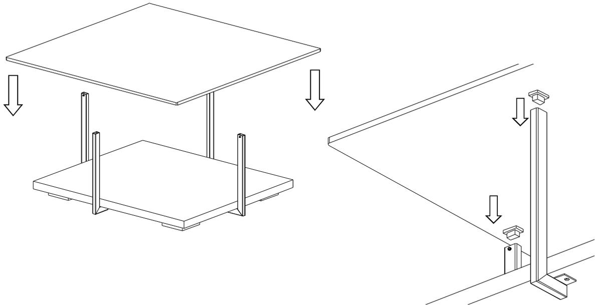
**Bild 4, Glasplatte verschrauben**
