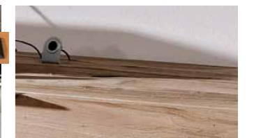
E-Repeater: Gerät zum Kanalisieren der Funkwellen für die elektrischen Geräte innerhalb des Möbels. E-repeater: A device which channels the radio waves for the electrical equipment within the furniture. E-Repeater: Appareil de canalisation des ondes radio pour les appareils électriques à l'intérieur des meubles.
