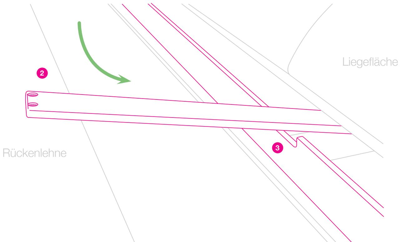
7. Das Auflagebrett anschließend mit 2 Stück Linsenschrauben M6x30 inkl. 2 Stück Beilagscheiben M6 mit der Sockelrahmenhinterseite verschrauben.
