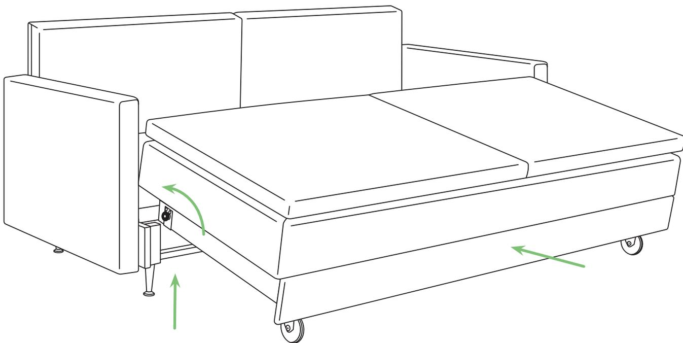
5. Mit der Handfläche in die vorgesehene Griffmulde **1** greifen und bis zum Anschlag vorziehen. Im Anschluss den Stauraum öffnen.
