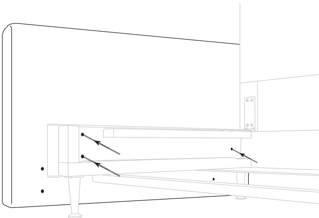
4. Anschließend den Ausziehteil einhängen und einschieben.
