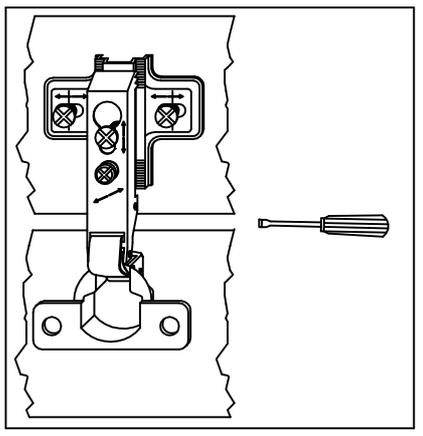
⚠️ Bei Türmontage das Scharnier einhängen, bis Anschlag öffnen und anschließend festschrauben.
