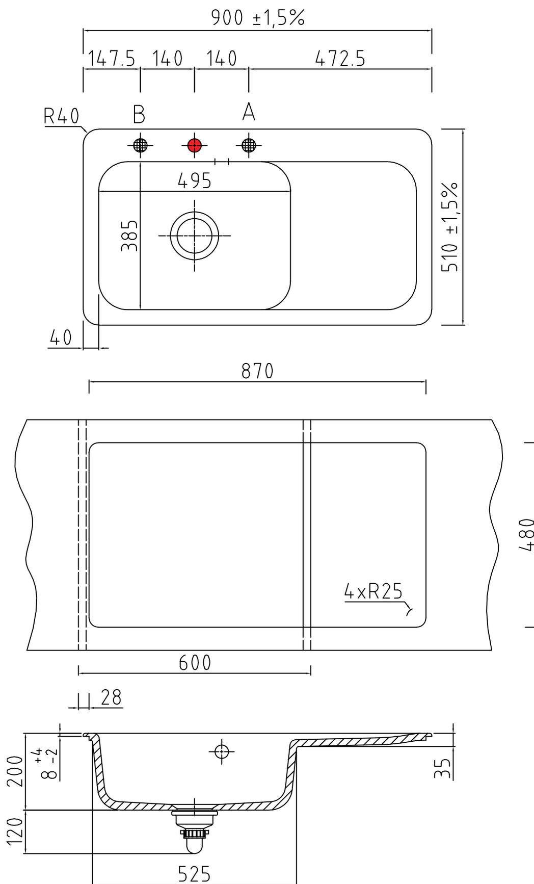
● Armaturbohrung vorhanden. Keine Sollbruchstellen. Bohrungen nach individueller Anordnung (● Pos. A und B, siehe Zeichnung).
