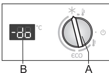
Falls die Gerätetür länger als 1 Minute geöffnet ist, erscheint auf dem Display **B** das Wort „do“.
