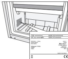
Das Typenschild mit den Grunddaten des Geräts befindet sich im Geräteinneren. Es enthält Informationen über die Spannung, das Brutto- und Netto-Volumen, die Art und die Menge des Kältemittels sowie Informationen über die Klimaklasse. Falls das Typenschild nicht in Ihrer Sprache ist, überkleben Sie es mit dem entsprechenden beigelegten Etikett.
