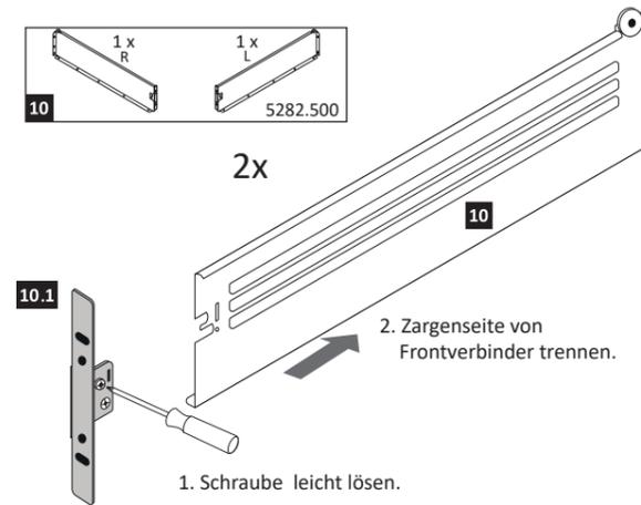
1. Schraube leicht lösen.
