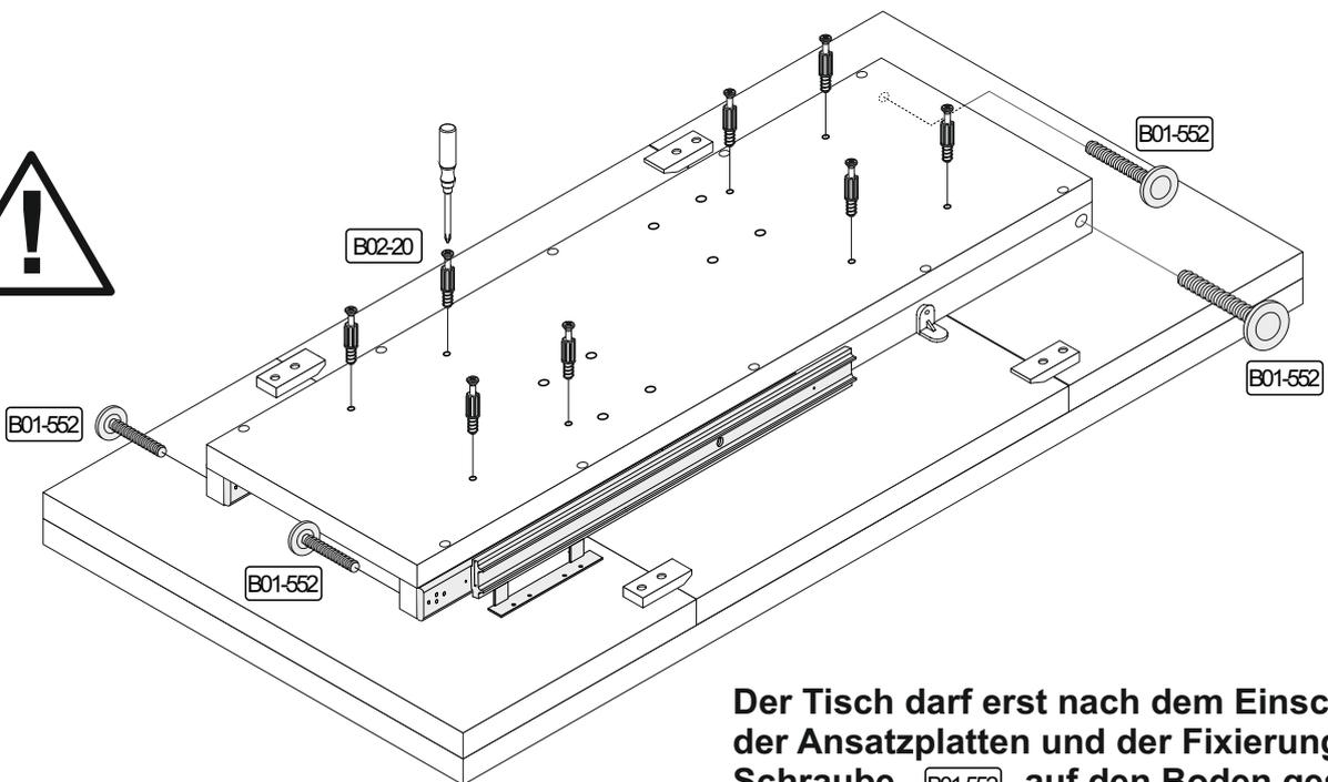
**Der Tisch darf erst nach dem Einschieben der Ansatzplatten und der Fixierung mit der Schraube B01-552 auf den Boden gestellt werden!!!**
