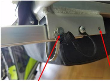
Position für Sicherheitsclip, wenn der Ausleger in „Anhängers Position“ ausgeklappt ist
