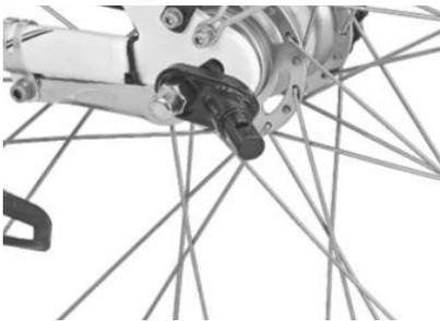
3. Bringen Sie die Anhängerkupplung wie abgebildet in Fahrstellung auf der Hinterrachse an und setzen die Achsmutter wieder auf das Achsengewinde.
