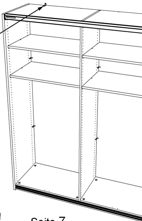
**12.** ⚠ Sicherungen zum einhängen der Schiebetür öffnen!
