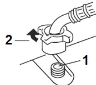
**HINWEIS!** Ziehen Sie den Wasserzulaufschlauch nicht zu stark an. Dadurch könnten die Ventile beschädigt werden.
