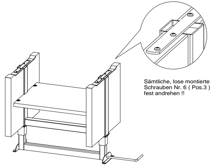
Sämtliche, lose montierte Schrauben Nr. 6 ( Pos.3) fest andrehen !!
