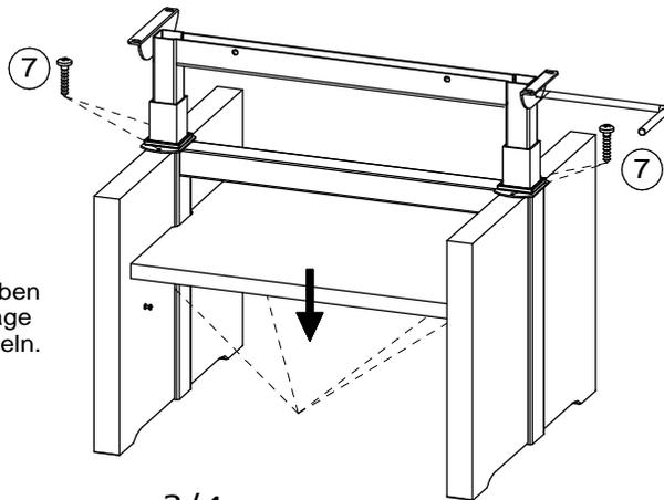
Boden auf die 4 Bolzen drücken und die Schrauben der Verbindungsbeschläge in der Unterseite verriegeln.
