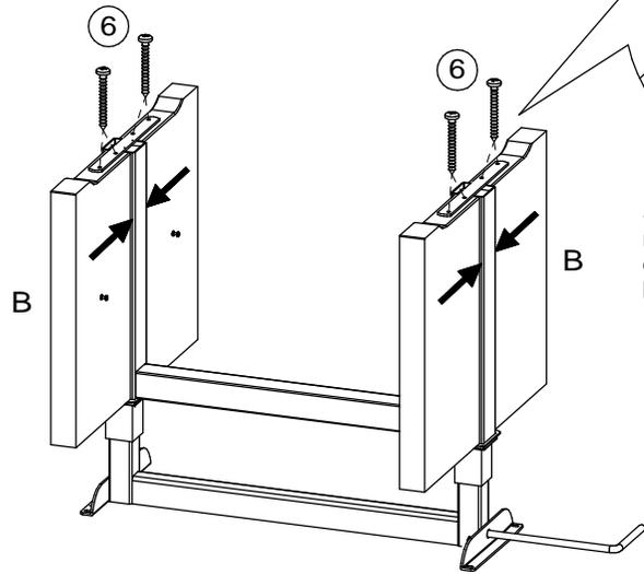
Schrauben Nr. 6 zunächst nur lose eindrehen, um die Montage des Ablagebodens zu erleichtern !!
