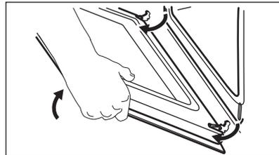
4. Legen Sie die Backofentür auf einer stabilen Oberfläche auf einen weichen Lappen und lösen Sie das Verriegelungssystem, um die innere Glasscheibe zu entfernen.
