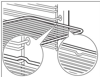
Schieben Sie den Rost mit den Füßen nach unten zwischen die Führungsstäbe der Einhängegitter.
