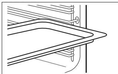
Schieben Sie das Backblech zwischen die Führungsstäbe der Einhängegitter.
