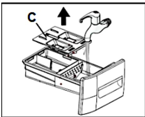
4. Reinigen Sie alle Teile des Waschmittelschubfachs mit warmem Wasser. Sie können zur Reinigung auch eine weiche Bürste verwenden.
