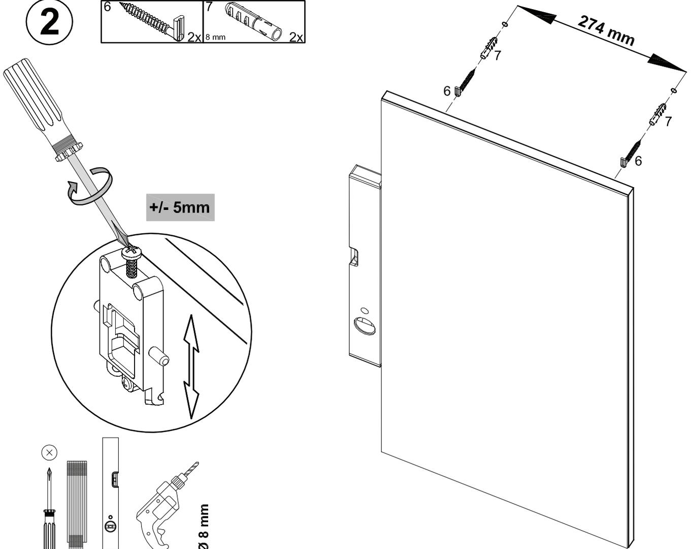
**DE Montagehinweise:** Vor dem Bohren den Verlauf von Strom- und Wasserleitungen unbedingt überprüfen und berücksichtigen! Bei der Wandmontage ist darauf zu achten, dass der Schrank nicht auf leitfähigen Oberflächen und nur am festen Mauerwerk montiert wird. Das beiliegende Montagematerial ist geeignet für übliches, festes Mauerwerk. Informieren Sie sich vor der Wandmontage über das geeignete Montagematerial für Ihre Wand und tauschen Sie es ggf. aus.
