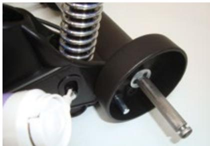
1. Sprühen Sie sowohl innen als auch außen an den beiden Hinterrädern Öl in die Federungsauflhängung.
