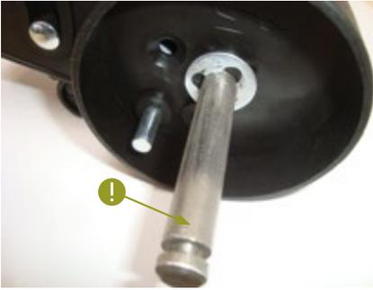
1. Entfernen Sie die Hinterräder und fetten Sie deren Achsen ein.
