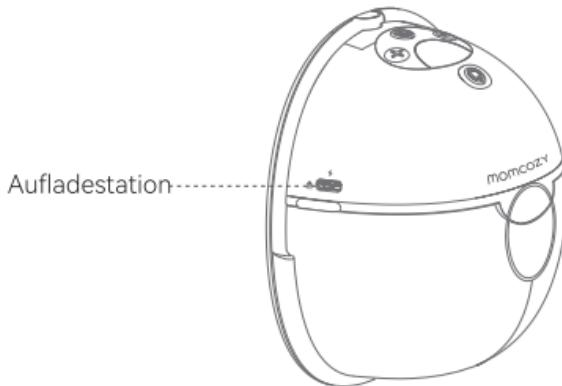
Abb. 4 Position des Ladeanschlusses
