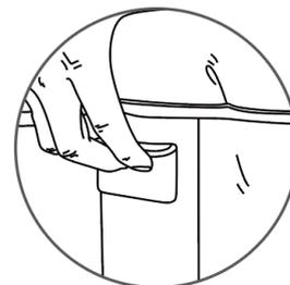
2b. Spustite nastavitvene ročice, da zaklenete posteljico v položaju.
