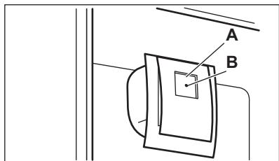
**i** Avant de mettre l'appareil hors tension, n'oubliez pas d'éteindre le ventilateur en appuyant sur le bouton (A). Le voyant vert (B) disparaît alors.
