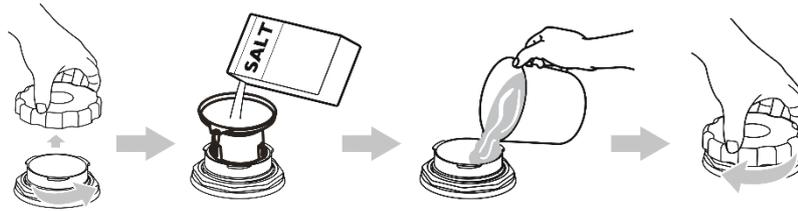
1. Unteren Korb entfernen, Kappe des Salzbehälters abschrauben und abnehmen.
