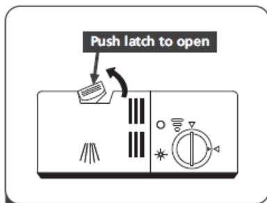
Zum Öffnen des Behälters die Taste in Pfeilrichtung schieben und loslassen. Der Deckel springt auf.
