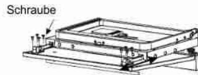
1. Zum Entfernen des Sprüharms die Schraubenmutter nach rechts drehen, um die Unterlegscheibe auf dem Sprüharm herauszunehmen und dann den Sprüharm selbst entfernen.
