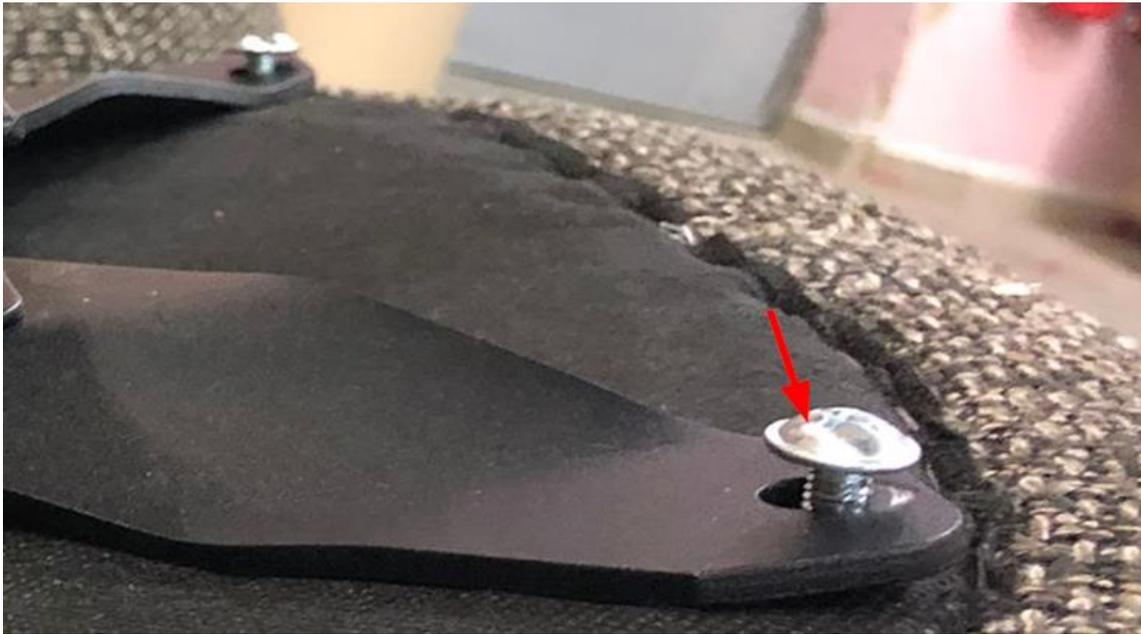
Wenn **alle 4 Schrauben** ca. 3-4 mm tief eingedreht sind, bitte **das Untergestell mittig ausrichten** und **abwechselnd** alle 4 Schrauben weiter festziehen.
