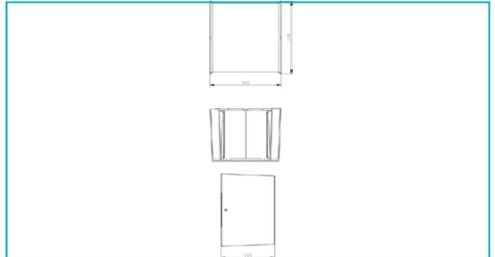
Die LED-Wandaufbauleuchte ARCTURUS präsentiert sich im modernen Cube-Design [wahlweise auch in länglicher Form] und eignet sich für die flexible Beleuchtung im Außenbereich. Über ein integriertes Shutter lässt sich der Abstrahlwinkel der IP54-Leuchte zwischen 0° und 90° anpassen, um je nach Anwendungsbedarf ein unterschiedliches Lichtbild zu generieren. Geschützt im dunkelgrauen Aluminium- Druckgussgehäuse sitzen die beiden High- Power-LED, die ein warmweißes, 5,5 W starkes Licht erzeugen.
