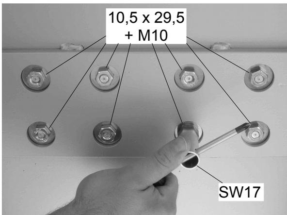
7. Mit je einer Unterlegscheibe und einer Mutter die Bolzen der Füße fixieren. Dazu die mitgelieferte Stecknuss verwenden.
