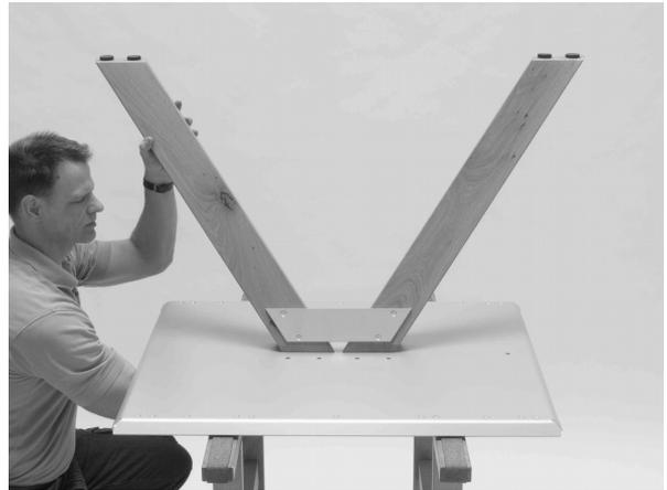
6. Das erste Fuss-Paar mit den Bolzen in die Plattenträgerwanne einstecken.
