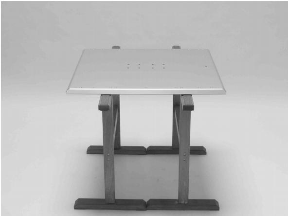
5. Die Plattenträgerwanne auspacken und umgedreht auf den gepolsterten Montageböcken ablegen.
