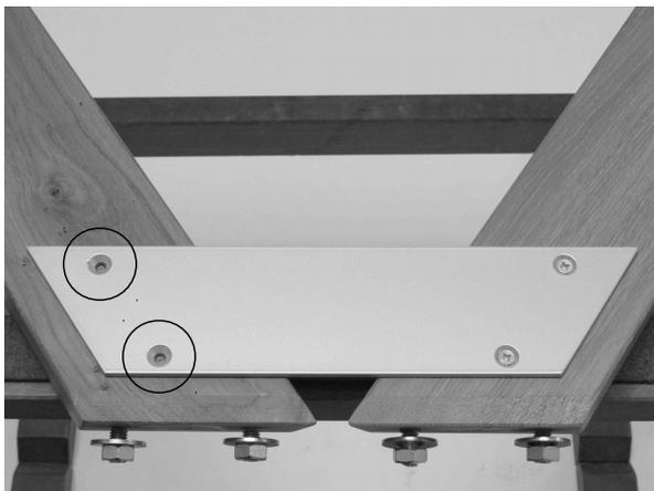
3. Die Bohrungen des Halblechs über den Markierungen positionieren.
