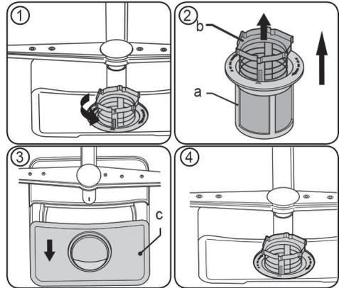
Drehen Sie die Filterkombination zum Entfernen und Reinigen gegen den Uhrzeigersinn und nehmen Sie sie durch Anheben nach oben heraus (1).
