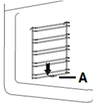
2. Schwenken Sie das Seitenrack in einem Winkel von ca. **45 Grad** nach innen; s. Abb. rechts, Pfeil.
