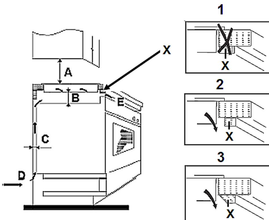
**C = BELÜFTUNGSSCHLITZ**
