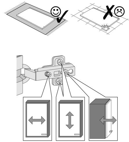
Das beigelegte Wandbefestigungsmaterial (Dübel und Schrauben) eignet sich nur für festes Mauerwerk (z.B.: Beton- oder Ziegelwände). Für andere Wandaufbauten sind eventuell Spezialdübel und andere Schrauben notwendig. Ziehen Sie gegebenenfalls eine Fachkraft zu Rate.
