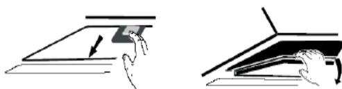
2. Inserte y gire los filtros de carbón activado (Fig.9) en ambos lados hasta que encajen.
