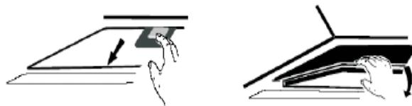
2. Τοποθετήστε τα φίλτρα ενεργού ἀνθρακα (Εικ.9) και στις δύο πλευρές και περιστρέψτε τα, μέχρι να ασφαλίσουν.
