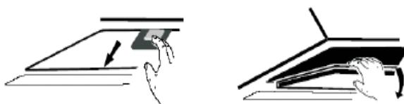
2. Sätt in aktivkolfilter (bild 9) på båda sidorna och vrid till dess att det hakar i.
