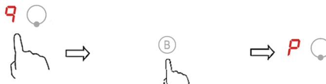
3. Das beschleunigte Aufheizen durch die BOOSTER - FUNKTION dauert **5 Minuten** an. Danach arbeitet die Kochzone wieder in der vorherigen Einstellung. Auf der Leistungsstärkenanzeige wechselt die Anzeige von "P" zu der Einstellung "9".
