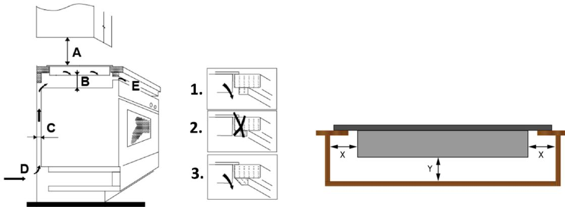
**D = BELÜFTUNGSSCHLITZ / E = LUFTAUSSLASS**
