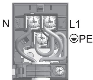
Das Anschlusskabel unbedingt durch eine Zulentlastungsklemme führen, die das Kabel vor dem Herausziehen schützt. Das Anschlusskabel muss so an der Rückwand des Geräts verlegt werden, dass es die Rückseite des Kochfeldes nicht berührt, weil sich diese während des Betriebs stark erwärmt.
