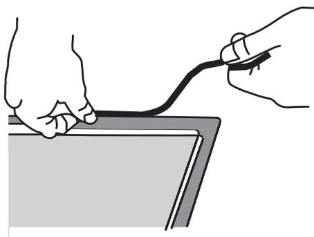
Zuerst das Kabel in den Ausschnitt verlegen und dann das Gerät in die Mitte des Ausschnitts einsetzen.
