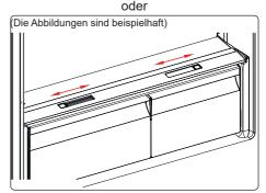
Bei vollem Gemüsefach sollte der Frischeregler vorne am Gemüsefach geöffnet werden. So kann die Luft und die Feuchtigkeit im Gemüsefach reguliert werden, um die Haltbarkeit der Lebensmittel im Fach zu verlängern. Wenn sich Kondenswasser am Glasablagefach bildet, muss der Frischeregler hinter dem Fach geöffnet werden.
