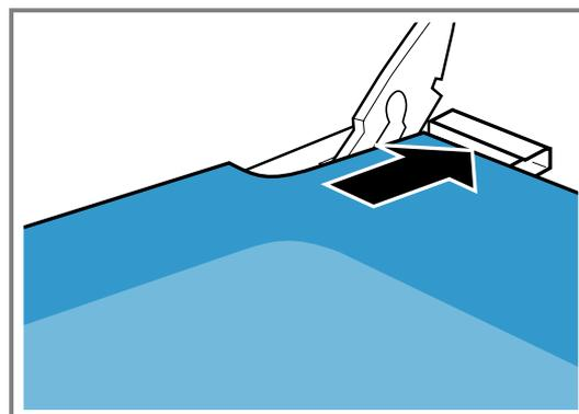
Die Scheibe in die beiden Öffnungen an der Unterseite einführen. Die glatte Fläche muss außen und die raue Seite innen sein.
