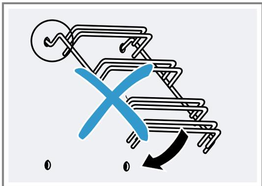
3. Beide Haken müssen vollständig in den oberen Löchern eingehängt sein. Das Gestell langsam und vorsichtig nach unten bewegen und in die unteren Löcher eingehängen.
