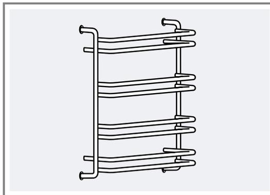
Bei richtig montierten Gestellen ist der Abstand zwischen den zwei oberen Einschubhöhen größer.
