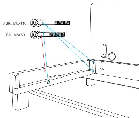
2. Den Stoffbezug an den Stellen, an denen die Schrauben gegen den Bezug drücken, mit einer Schere aufschneiden und die Schrauben durchschieben.
