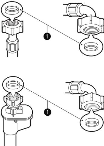
Versorgungsschlauch mit keinem mechanischen Gerät zu fest an.
