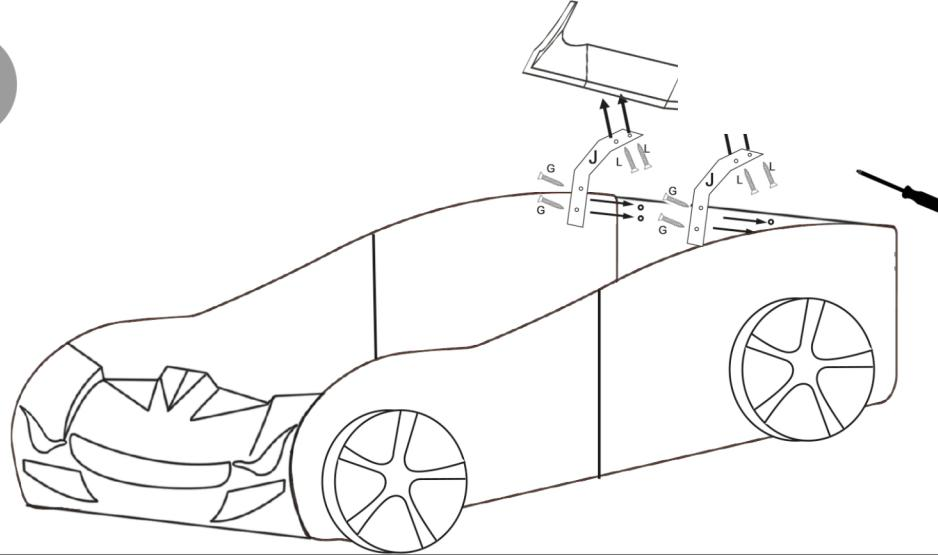
Montieren Sie das kurze Seite am Spoiler und das lange am Auto.
