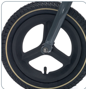
Introduceți garnitura pentru roata din față și strângeți șuruburile.
