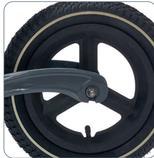
Introduceți garnitura pentru roata din spate și strângeți șuruburile.
