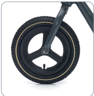
Montați roata frontală: Montați roata frontală în furcă.
