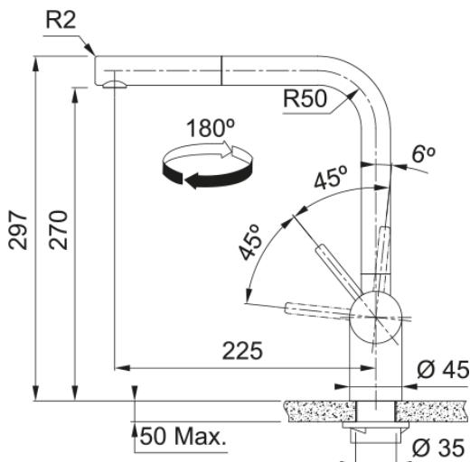
Atlas Neo Zugauslauf, massiv Edelstahl, DVGW, Hochdruck, Easy Installation, Silent, Laminarstrahl, Kugelgelenk, Schwenkbereich 180°, Hebel rechts, Schlauchlänge 45 cm
