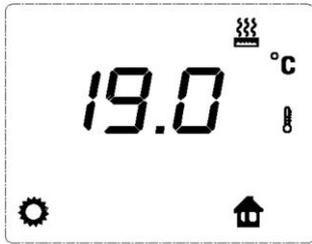
Die Maschine arbeitet automatisch gemäß dem von der Signalleitung eingegebenen Betriebsart und zeigt: eingestellte Zeit (19 °C für den Komfortbetrieb, 18 °C für den Komfort -1 Betrieb, 17 °C für den Komfort -2 Betrieb, 15,5 °C für den Sparbetrieb, 7 °C für den Frostschutzbetrieb, wird im Aus-Zustand nicht angezeigt), Die FP-Signalleitung steuert den Betriebsmodus und das Heizungssymbol
