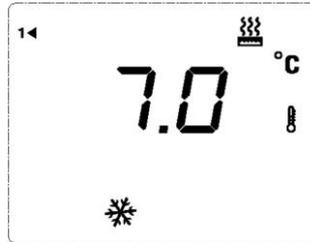
beträgt 7 ° C, wie in der Abbildung dargestellt: , Die Temperatur für den Frostschutzmodus kann nicht geändert werden.
