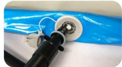
④ Öffnen Sie den Ventildeckel (gegen den Uhrzeigersinn).
