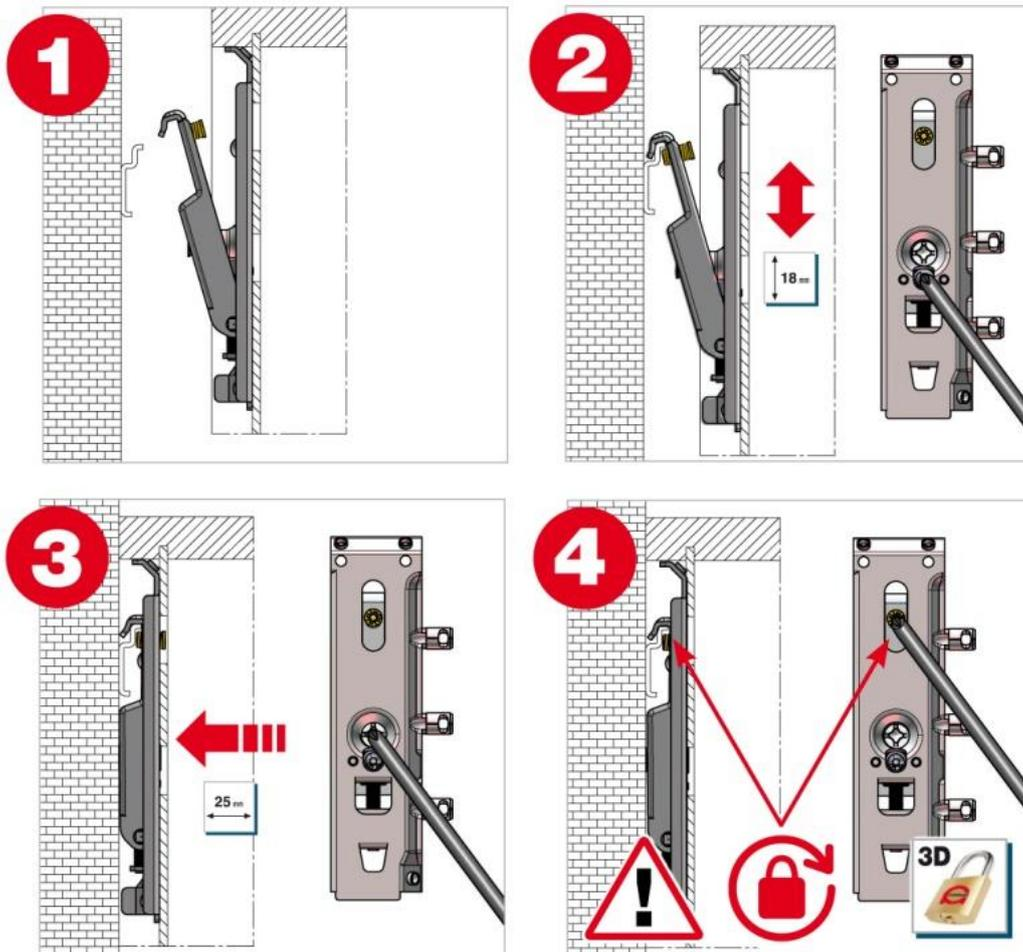
5. Jetzt muss die Aushebesicherung eingeschraubt werden (siehe Abbildung 4), hierdurch wird ein unbeabsichtigtes Aushängen des Schrankes verhindert.
