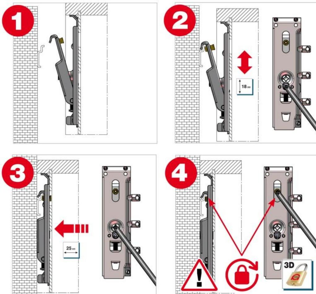
6. Jetzt muss die Aushebesicherung eingeschraubt werden (siehe Abbildung 4), hierdurch wird ein unbeabsichtigtes Aushängen des Schrankes verhindert.
