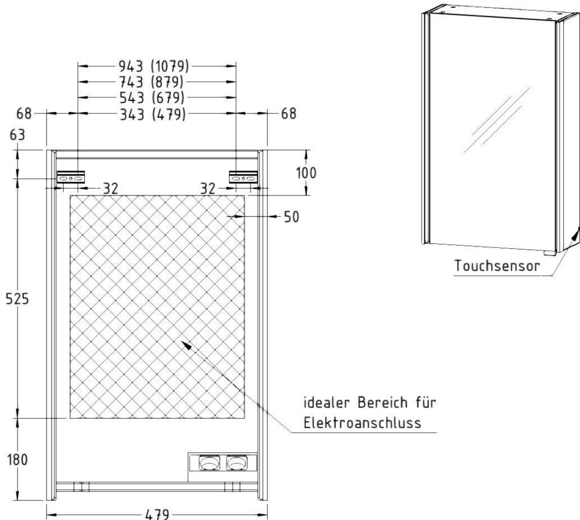
4. Nun kann der Spiegelschrank aufgehängt werden und anschließend von innen durch die Bohrungen, sowohl in der Höhe (siehe Abbildung 2 / Seite 8), als auch in der Tiefe (siehe Abbildung 3 / Seite 8) ausgerichtet werden.
