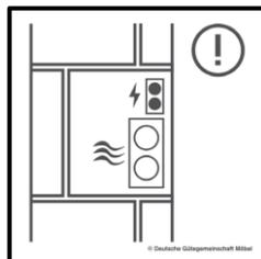
Im Befestigungsbereich dürfen keine Elektro-, Versorgungs- und Entsorgungsleitungen verlaufen. Der Elektroanschluss ist nur vom Fachmann unter Berücksichtigung der IEC 60364 und national geltender Richtlinien durchzuführen!
