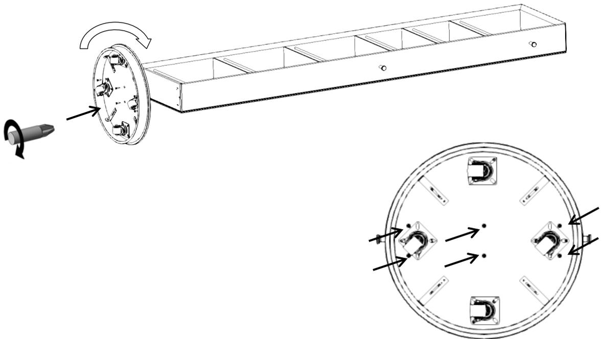
3. Standspiegel aufstellen, die Haken mittels mitgelieferter Gewindestifte in die vormontierten Muffen montieren.
