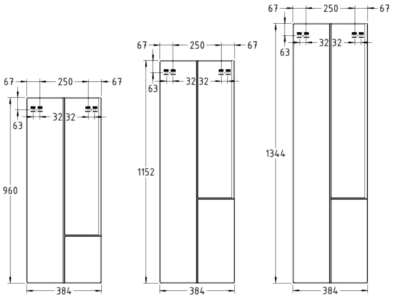
1. Der Hängeschränk wird mit 2 vormontierten Beschlägen und 2 Wandschienen an der Wand befestigt.
