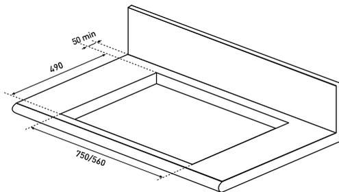
Für den flächenbündigen Einbau umlaufend
