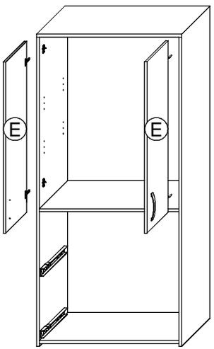
**T11** Bei Türmontage das Scharnier einhängen, bis Anschlag öffnen und anschließend festschrauben.
