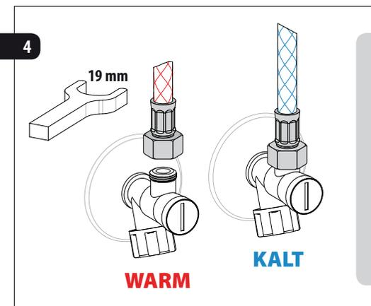
Verbinden Sie die Flexschläuche mit dem Wandanschluss:
