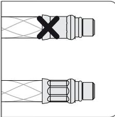
Kein Hanf oder Teflon um die Gewinde wickeln, die Dichtigkeit wird mittels O-Ring gewährleistet
