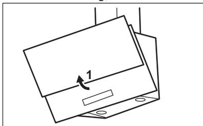
2. Drücken Sie den Griff der Befestigungsklammer an der Filtertafel unterhalb der Dunstabzugshaube (1).
