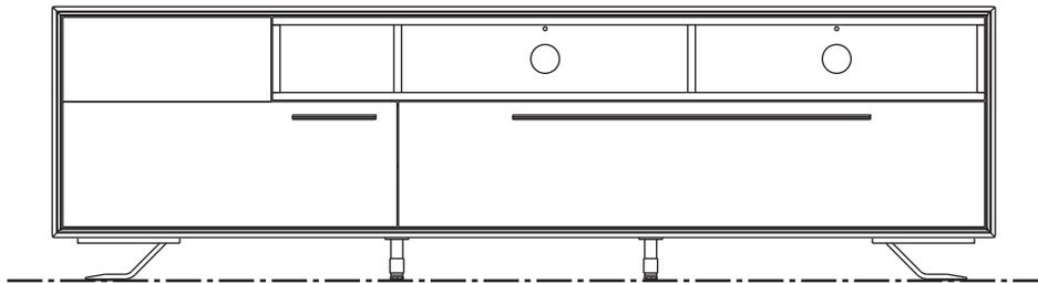
**Die mittleren Drehfüße bitte so einstellen, dass alle Füße (Drehfüße und Kufen) gleichmäßig den Boden berühren.**
