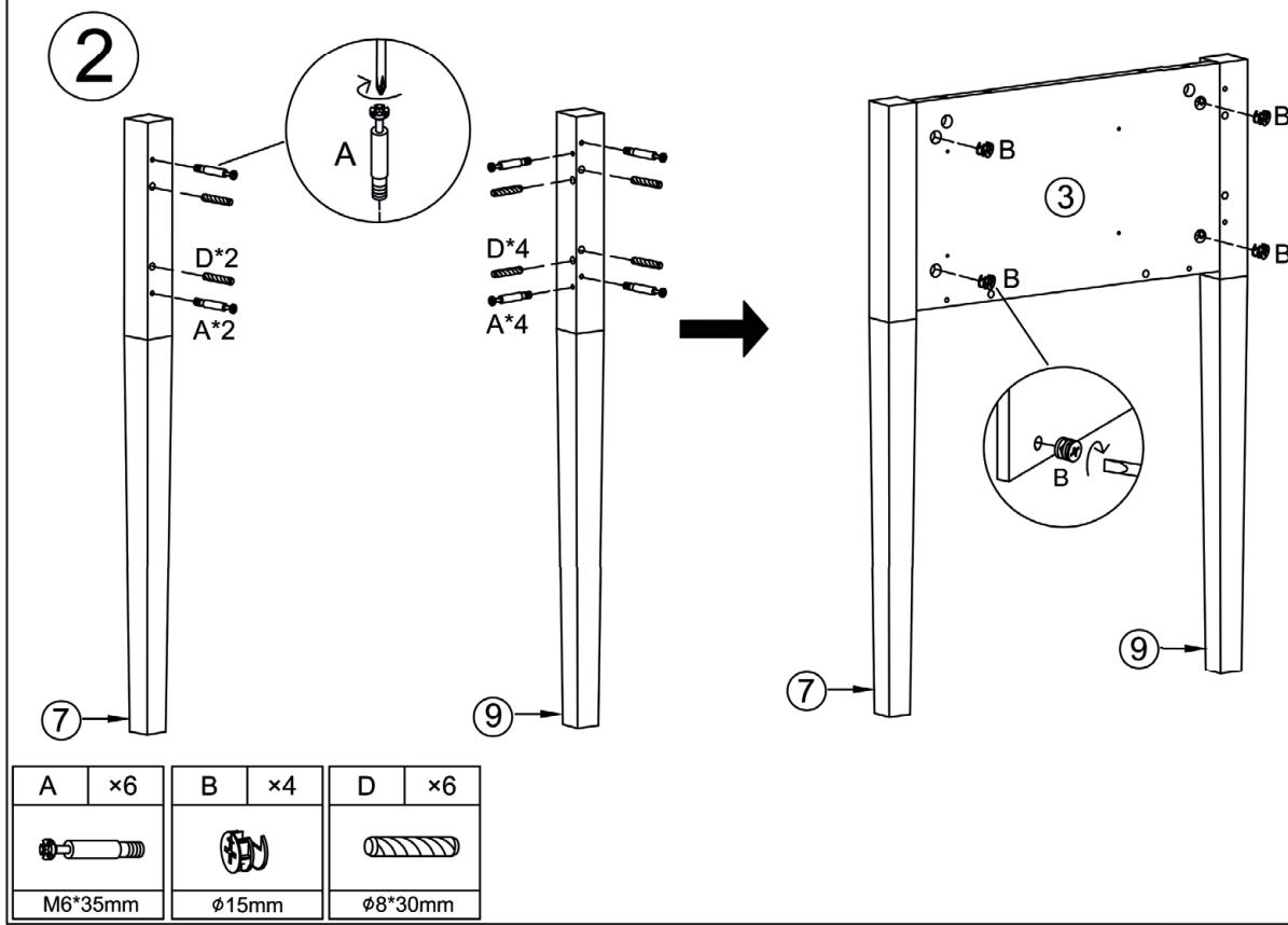
Beginnen Sie mit dem Testziehen der Schrauben auf der Mitte der Platte und dann erst nach außen hin langsam und der Reihe nach über Kreuz festziehen.
