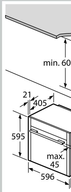
Wird das Gerät eingebaut, muss die Stärke (ggf. inkl. Frontplatte) beachtet werden
