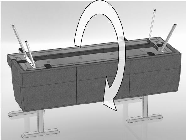
6. Die fertig montierte Bank drehen und auf den Boden stellen.
