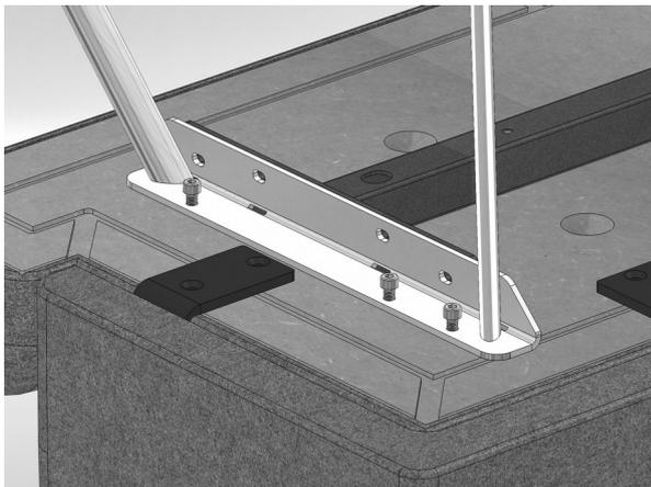
3. Zunächst beide Unterbau Bügel mit je 3 Schrauben lose verbinden.
